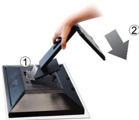
Una volta posizionato il pannello del monitor su una superficie soffice e su un cuscino, completare le procedure di seguito per rimuovere la base.
