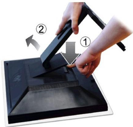
Una volta posizionato il pannello del monitor su una superficie soffice e su un cuscino, completare le procedure di seguito per attaccare la base.
