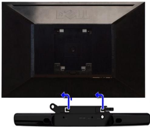
1. Operando sul retro del monitor, collegare la Soundbar allineando i due slot alle due alette lungo il lato posteriore del monitor.
